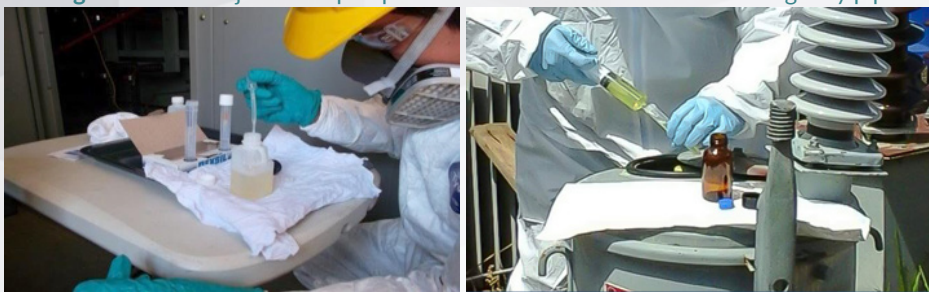
Fotografía 11. Trabajo de campo aplicando toma de muestras con tubo rígido y pipeta
