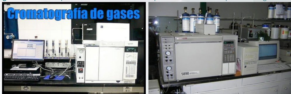
Fotografía 19. Análisis químico de aceites dieléctricos por método cualitativo por cromatografía de gases
