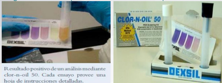
Fotografía 17. Análisis químico de aceites dieléctricos por método cualitativo
