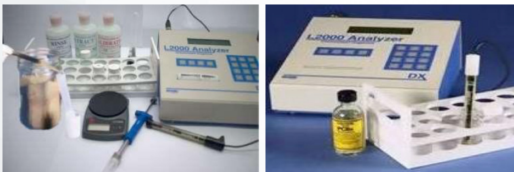
Fotografía 18. Análisis químico de aceites dieléctricos por método cualitativo
