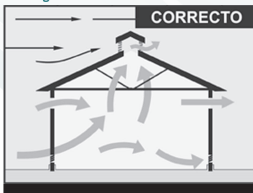
Figura 12. Almacén con ventilación
