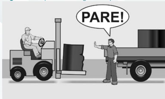
Figura 31. No permitir la carga de recipientes defectuosos
